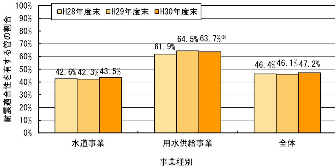
※地盤等の布設条件を考慮した耐震適合性の判断基準の厳密化等に伴い、用水供給事業の H30 年度末の耐震適合性を有する管の割合は H29 年度末と比べて微減している。
